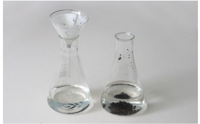
Joonis 1. Pildil on näha mudast vett, mis on pärast mehaanilist puhastust hariliku filterpaberi filtreeritud. Õpilased võivad katsetades proovida erinevaid etappide järjestusi, ka nn valesid variante.
